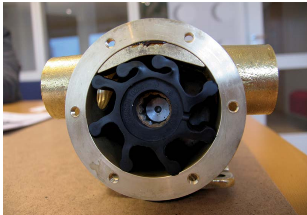
Her ses en SPX Johnson Pump Marine impeller i et pumpehus i en bådmotor.
